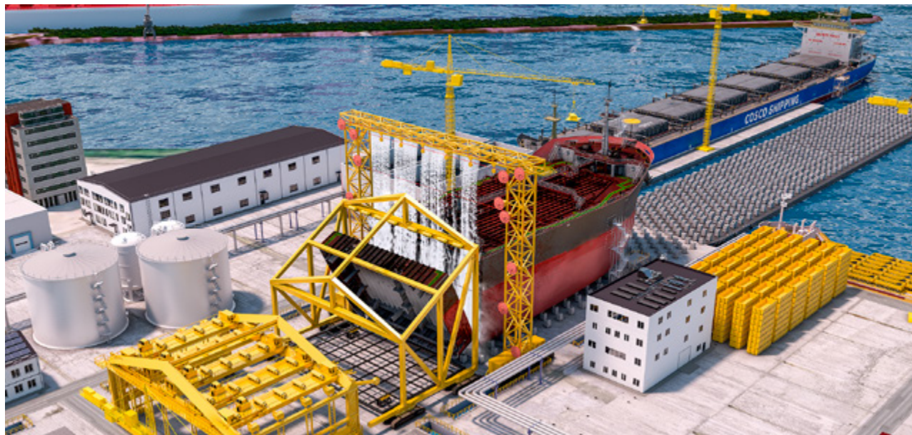
Zo ziet de geautomatiseerde scheepssloop van Marine Metals er straks uit: een speciale zaag maakt 'plakjes' van het schip.
